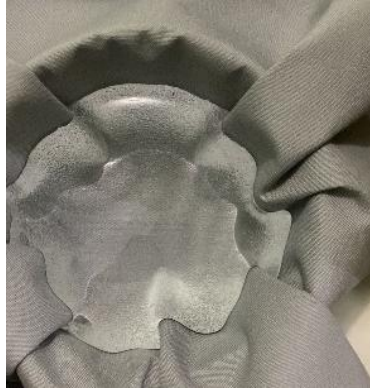
Gambar 8. Hasil uji coba kain pvc terhadap ketahanan air
